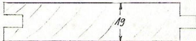
Bretter für Bodenplatte
